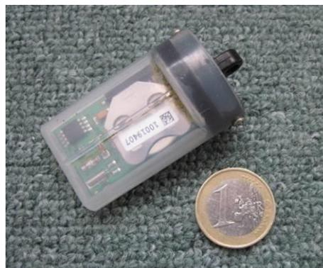
Fig. 19 : Sonde autonome Hobo
