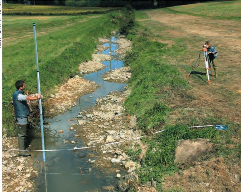
Relevé des caractéristiques physiques du cours d'eau : calcul de la pente du cours d'eau à l'aide d'un niveau et d'un mètre gradué.
